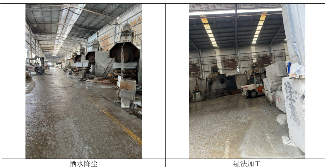
图 5 项目废气防治措施现场照片
