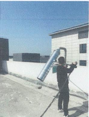
G5 喷砂废气排气筒监测
