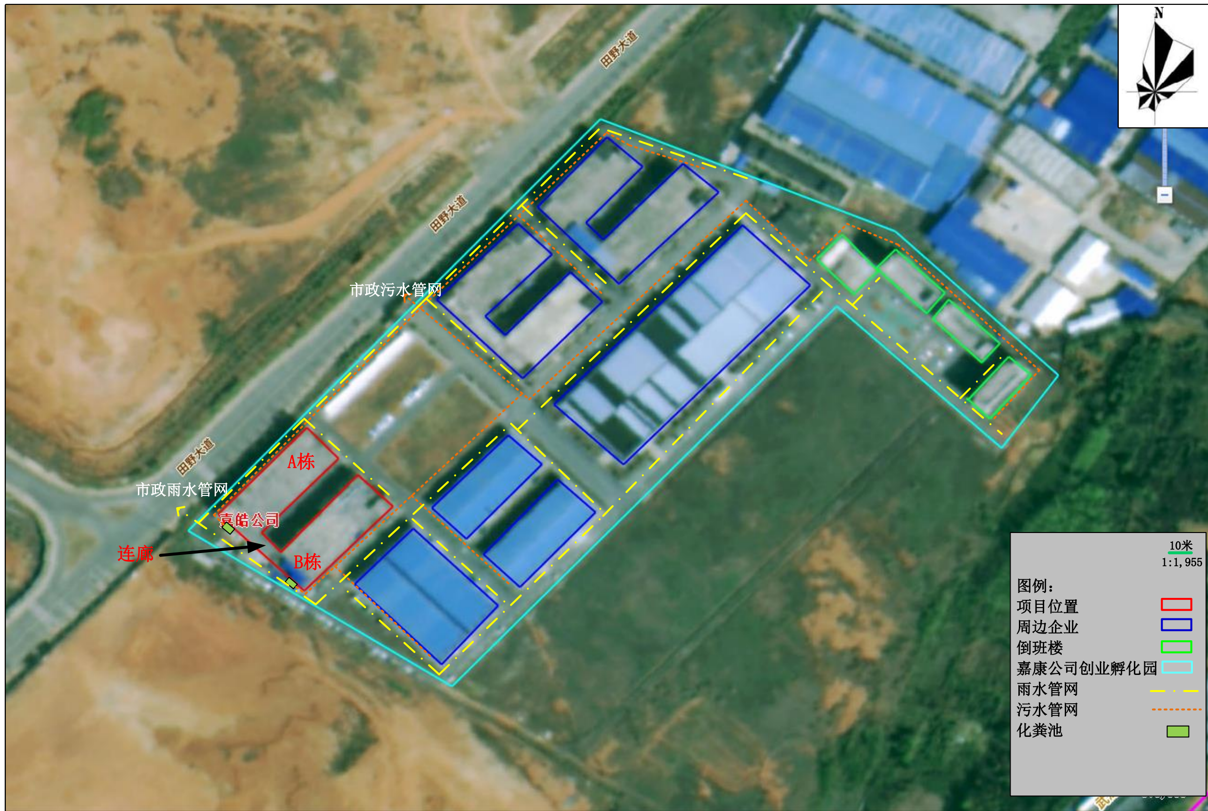
附图4： 项目所在园区雨污管网图
