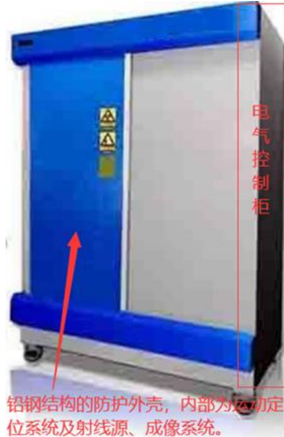
图 2-4 本项目工业 X 射线机外观示意图
