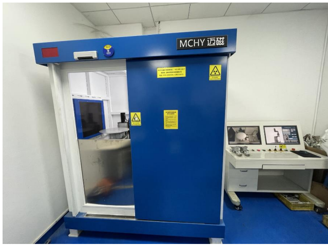
X 射线机整体及操作台
